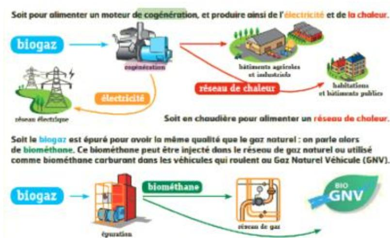
FIGURE 57 : UTILISATION DU BIOGAZ (SOURCE : VERS L'AUTONOMIE ENERGETIQUE DES TERRITOIRES - METHANISATION ET BIOGAZ, UNE FILIERE D'AVENIR - ATEE BIOGAZ)
