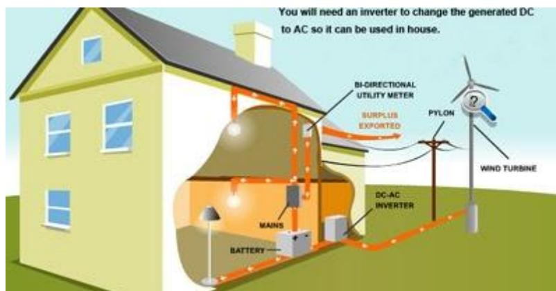
FIGURE 4848 : EXEMPLE D'UNE INSTALLATION MICRO-EOLIENNE
