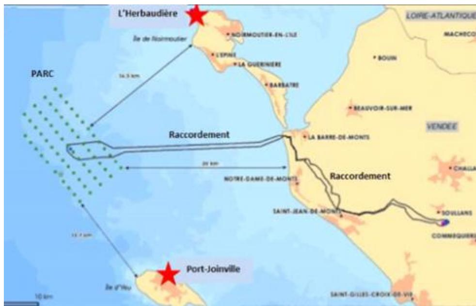
FIGURE 86 : SCHEMA D'IMPLANTATION DU PARC EOLIEN OFFSHORE DES ÎLES D'YEU ET DE NOIRMOUTIER. SOURCE : RAPPORT DE LA COMMISSION D'ENQUETE PROJET EMYN.
