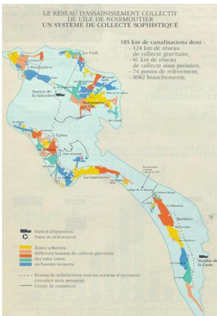
FIGURE 4343 : LE RESEAU D'ASSAINISSEMENT COLLECTIF DE L'ILE DE NOIRMOUTIER
