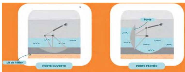
Figure 3 - Principe de fonctionnement des portes secteurs
