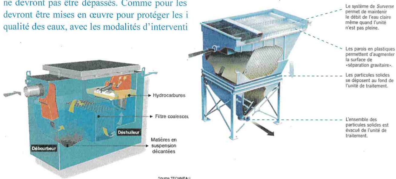
Principe de fonctionnement de modules de filtration
